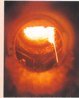
スラグホールから流れ落ちるスラグ Molten Slag from Slag Hole
